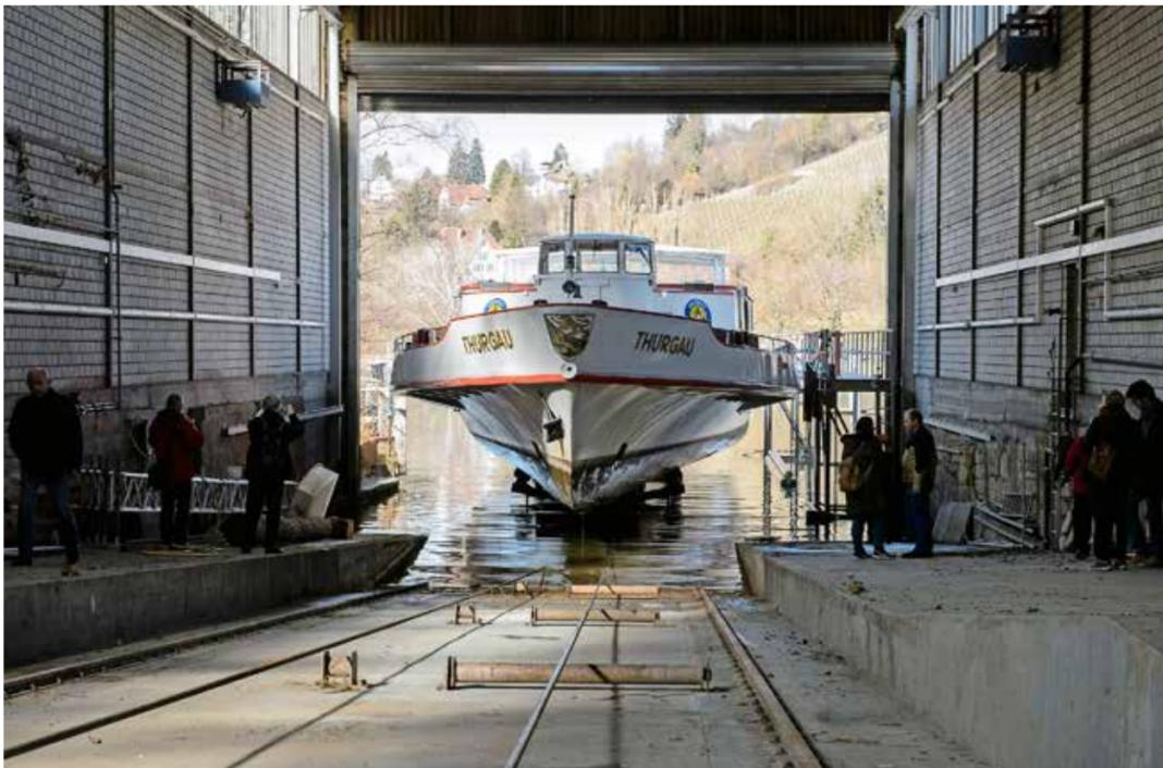
Mit dem Bug voran wird die rund 47 Meter lange «Thurgau», die auf einem Wagen vertäut ist, über die leichte Neigung der Rampe in die Werfthalle gezogen. Weil der Wagen keilförmig ist, bleibt das Schiff stets in der Waagrecht. Bilder Selwyn Hoffmann
